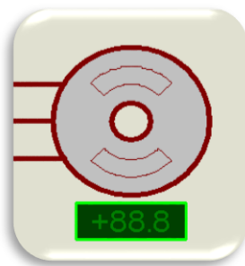
شکل 5-14- شمای موتور Servo در نرم افزار پروتئوس
